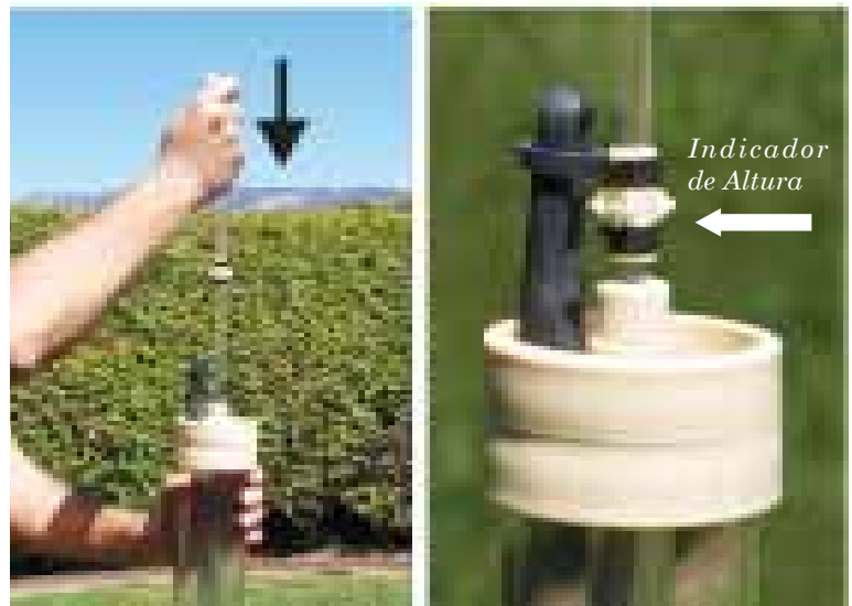
Figura 26. Conectando el Tubo de Aire Superior al Tubo de Aire Medio
